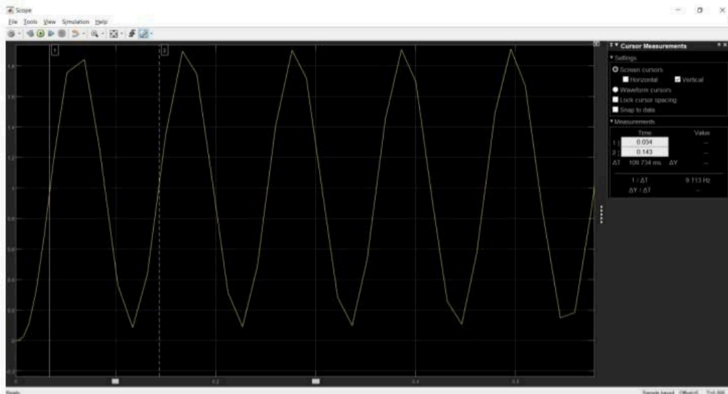
Рисунок 37 – Нахождение P_{cr} по графику передаточной функции системы с P регулятором
